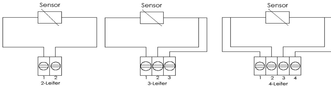
Das Anschließen der freien Drahtenden erfolgt bei Kabelfühlern analog mit Anschlusskopf! Bei Mehrleiterschaltung gehören jeweils die Drahtenden mit dunkler bzw. heller Isolierung paarweise zusammen.
